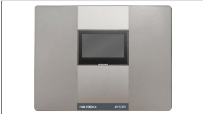
Zur Erweiterung der Heiz- und Boilerkreise sowie von Pufferspeichern und Fremdwärmekeßeln können bis zu 16 Heizkreisregler angeschlossen werden. Der Anschluss erfolgt mit einem Buskabel an der Kesselplatine (am CAN-Stecker).
